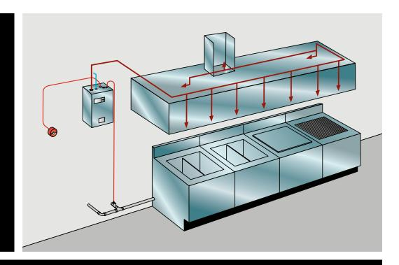
PRX™ LIQUID FIRE SUPPRESSANT ■ OVERLAPPING PROTECTION
